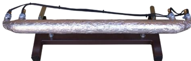
Рис. 1. Модуль «Исследование теплового процесса в теплообменном аппарате типа «труба в трубе»
